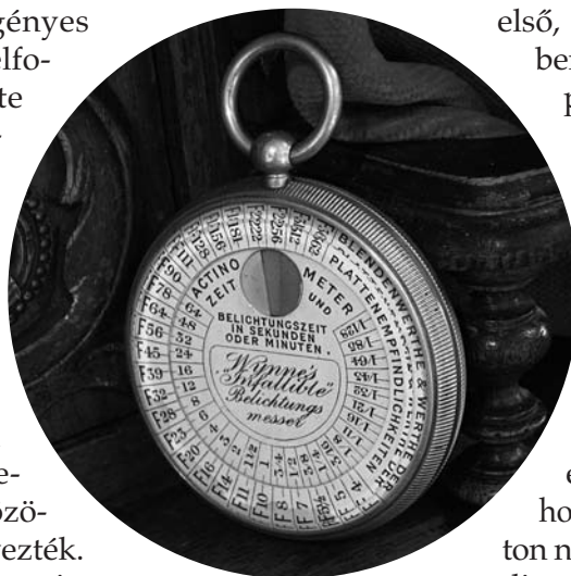
1. ábra. Angol gyártmányú, zsebóra formájú aktinóméter (kémiai fénymérő) az 1900-as évek elejéről
