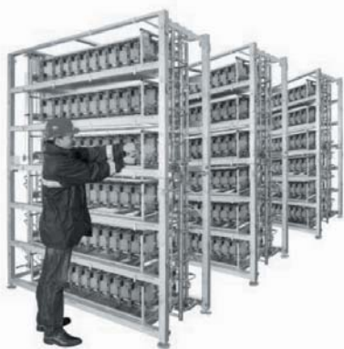
10. Ábra. Corning reaktorok párhuzamos elrendezése.
