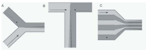
5. Ábra. Áramlási profilok különböző geometriájú csőszakaszoknál.
