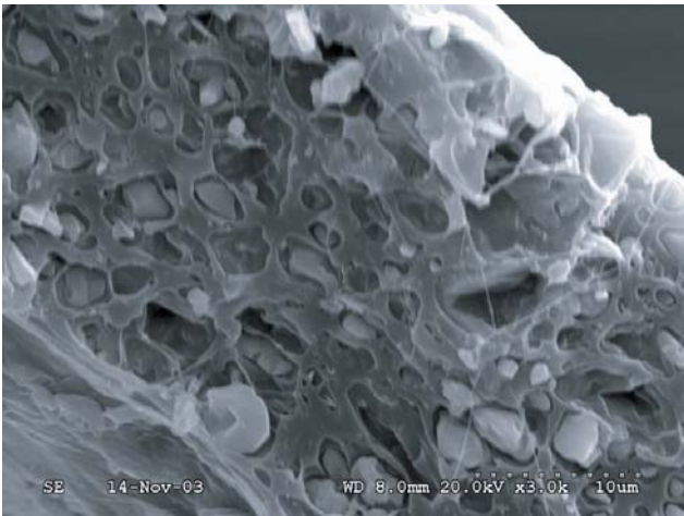
4. Ábra. Lélegző fólia keresztmetszetéről készült SEM felvétel.
