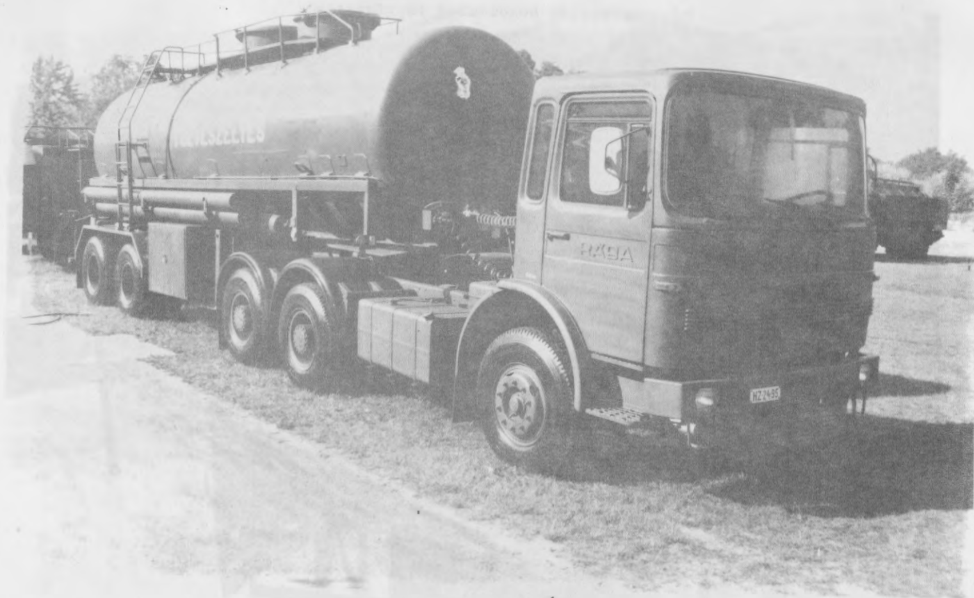
4.sz.fénykép: 24 m 3 -es üzemanyagszállító nyerges pótkocsi
