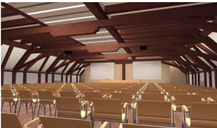
A Püspöki magtár és pince átépítése során, a 200 férőhelyes terem kialakításához szükséges a teljes tetőszelvény feszítávolsága így, 3 közbenső oszlop kiváltásával a terem mérete kedvező kialakítást nyerhet (Tervezőtárs: KIMA Stúdió)
