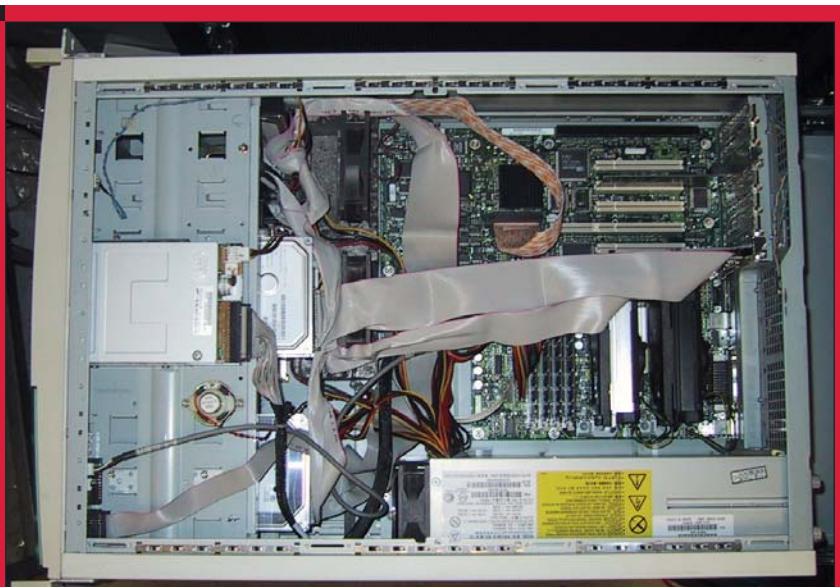
■ 1. ábra Egy öreg kiszolgálóból épített lemeztömb (kilenc IDE lemezt tartalmaz, amelyek közül öt egy SCSI RAID tagja) A kiegészítő IDE csatolók egy Promise HBA kártyán találhatók.
