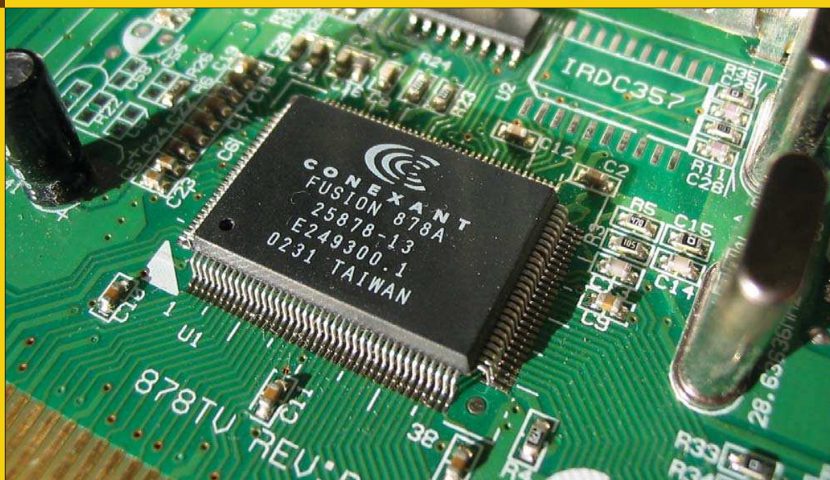
■ 1. ábra A kártya lelke: egy Brooktree 878-as chip
