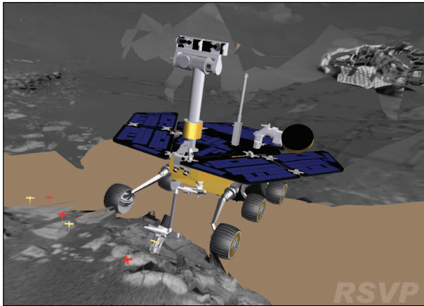
2. kép Egy szikla árfúrása a kókolató eszközzel
