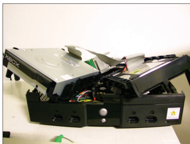
3. kép Az Xbox szétszedve. A Philips DVD-meghajtó a bal oldalon, a Seagate merevlemez pedig a jobb oldalon látható. A háttérben látható zöld áramkör egy modlapka, ami most egy számítógép párhuzamos kapujára csatlakozik
