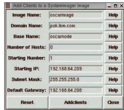
3. kép Ügyfelek hozzáadása a SystemImager-lenyomathoz
