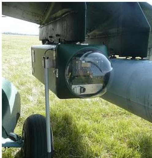
Mi-24-re függesztett ABV RIÉR konténer (Forrás: http://airbase.blog.hu/page/5 , letöltve: 2011.02.21., 21.40)
