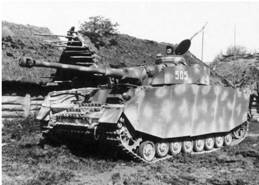
3. Kép: Kiegészítő (előtét) páncélzattal szerelt Pz IV harckocsi 1944-ben a Keleti fronton 3
