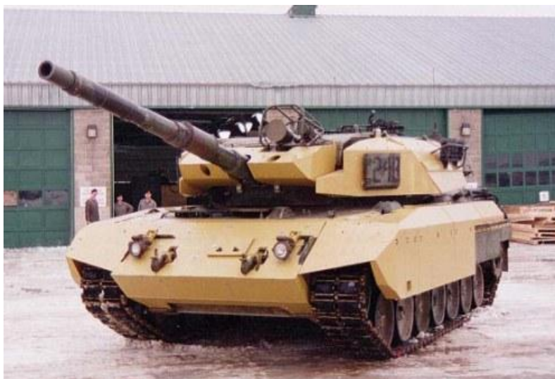
5. Kép: Leopard-1 harckocsi utólag felszerelt kiegészítő páncélzattal 5
