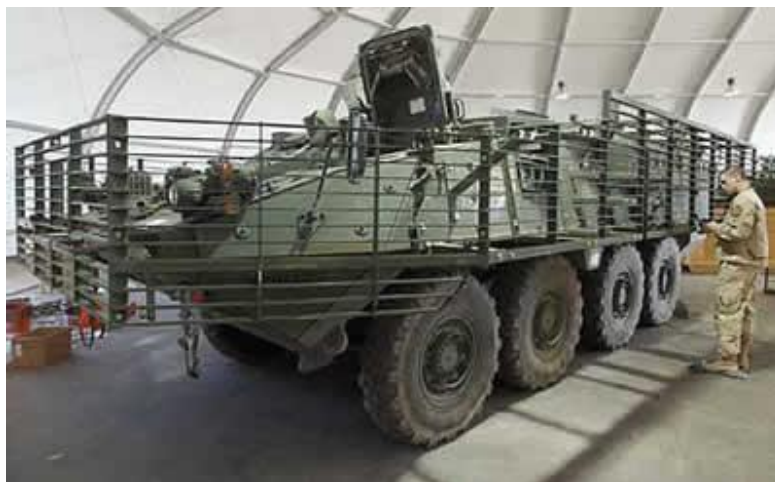
9. Kép: Stryker harcjármű „ketrec” kiegészítő páncélzattal 10
