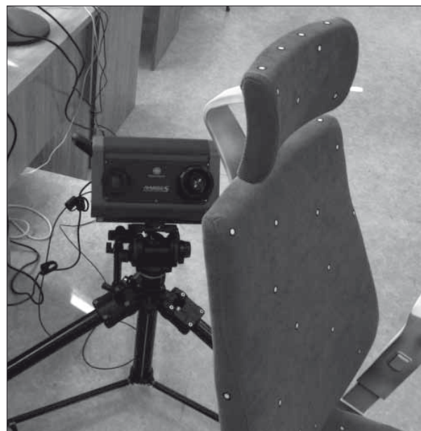
5. kép 3D szkennelés Konica Minolta Range 5 szkennelőkkel
