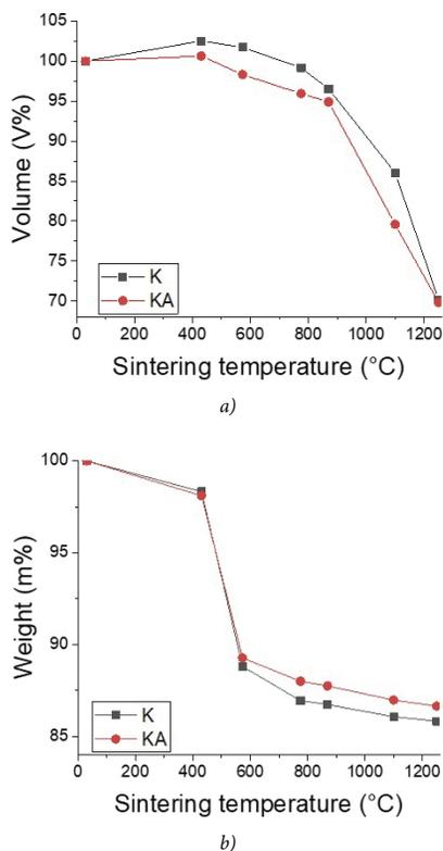
4. ábra Az (a) térfogat és a (b) tömeg változása különböző hőmérsékleten
