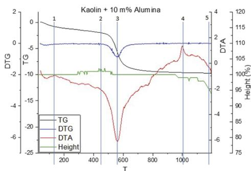
3. ábra Kaolin és alumínium-oxid keverék termoanalitikai görbéi
