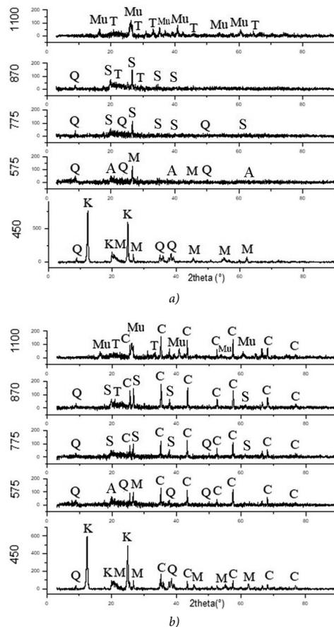
6. ábra A K (a) és KA (b) minta XRD mintája különböző szinterelési hőmérsékleten (A-andaluzit, C-korund, K-kaolinit, M-muskovit, Mu-mullit, S-szillimanit, T-tridimit, Q-kvarc)
