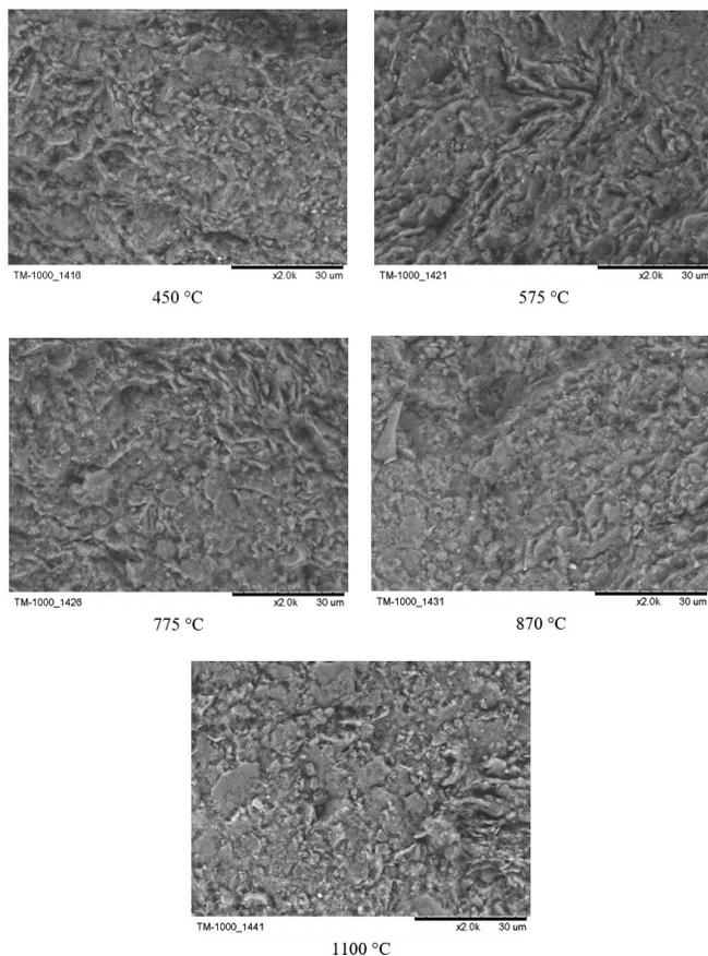
5. ábra A különböző hőmérsékleten szinterelt KA minták töretfelületének mikroszerkezete
