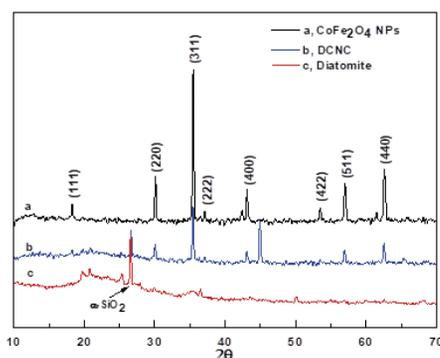
2. ábra A  $\text{CoFe}_2\text{O}_4$ NP-k, a diatomit és a DCNC XRD mintái, a  $\text{CoFe}_2\text{O}_4$  NP-k 1-10 közötti diatomit arányokkal
