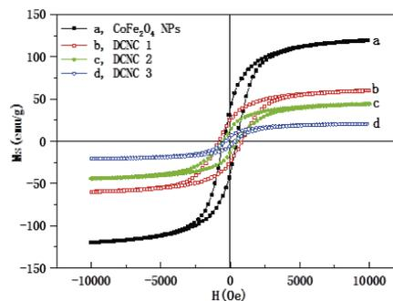
3. ábra A  $\text{CoFe}_2\text{O}_4$  NP és DCNC mágnesezési görbéi. DCNC 1 és DCNC 3  $\text{CoFe}_2\text{O}_4$ NP-ekkel, a diatomit aránya 1:2, 1:5, illetve 1:10 között
