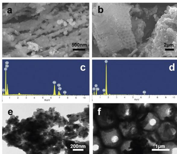
1. ábra FE-SEM EDX és TEM képekkel a  $\text{CoFe}_2\text{O}_4$  NP-k és a  $\text{CoFe}_2\text{O}_4$  NP-k DCNC-vel, a diatomit aránya 1: 10.  $\text{CoFe}_2\text{O}_4$  NP (a, e), DCNC (b, f). FESEM képek (a, b), FESEM-EDX a  $\text{CoFe}_2\text{O}_4$  NP-ről (c), DCNC (d). TEM képek (e, f)
