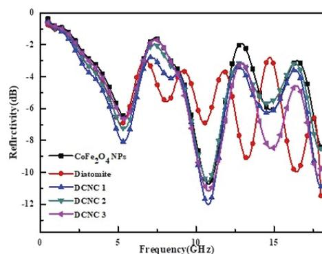
5. ábra A  $\text{CoFe}_2\text{O}_4$  NP-k, a diatomit és a DCNC mikrohullámú abszorpciós tulajdonságai. DCNC 1 és DCNC 3  $\text{CoFe}_2\text{O}_4$ NP-kkel, a diatomit aránya 1: 2, 1:5, illetve 1:10 között
