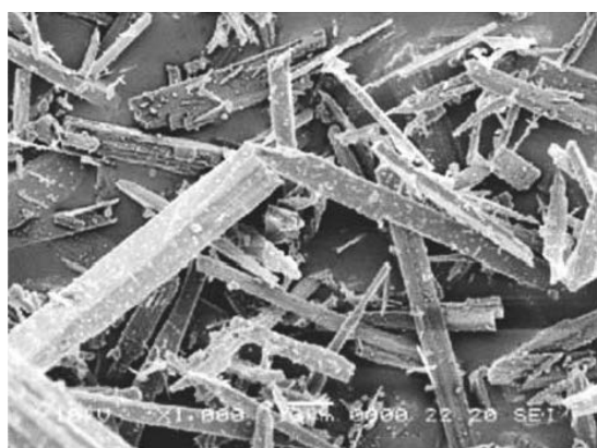
Fig. 6. Fibrous structure of wollastonite ( http://www.google.com.tr/imgres ) 6. ábra Wollastonit szálas szerkezete ( http://www.google.com.tr/imgres )
