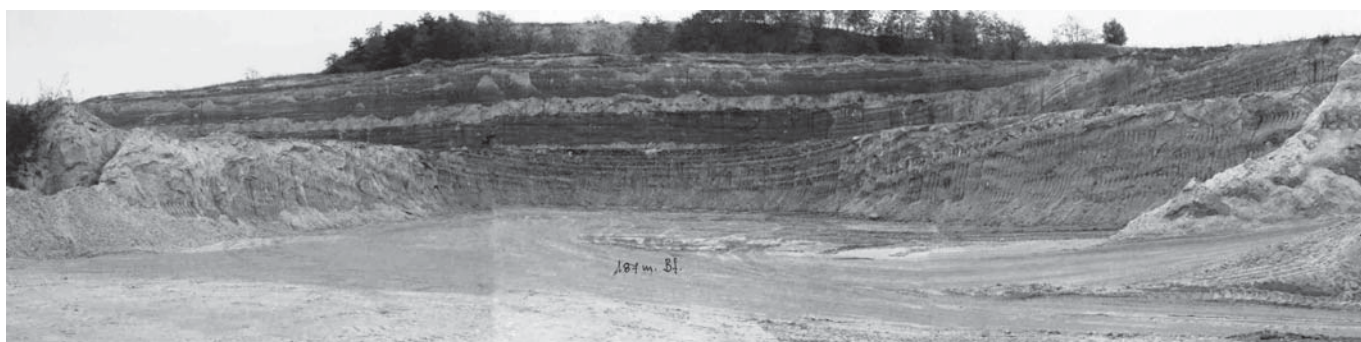
9. ábra Rétegdőlés irányába művelt bányafal az üzem délkeleti részén Fig. 9. Quarry-wall worked in the direction of the dip of strata at the southeastern part of the mining works
