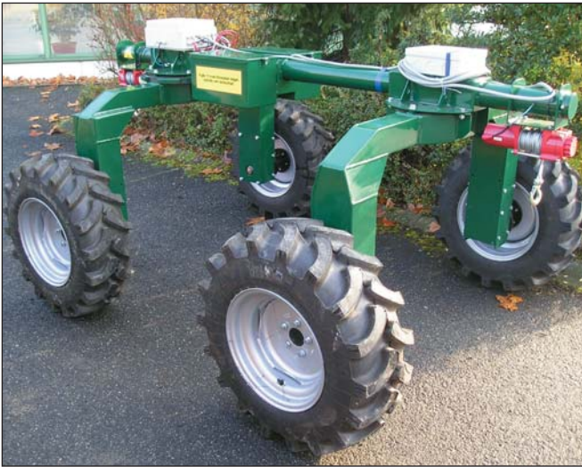
2. kép. A gép prototípusa, az EEK-2 típusú erdészet elektromos közelítőgép
