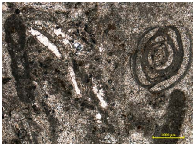
4. ábra - A 4. számú minta vékonycsiszolati képe. 1N - II. típus: ősmaradványos mészkő sok molluszka-töredékkel és miliolid foraminiferákkal.
