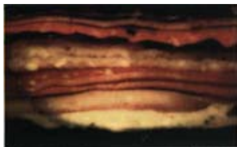
5. kép. A 4. képen látható faszobor arcáról vett minta sztereo mikroszkópos keresztmetszeti képe
