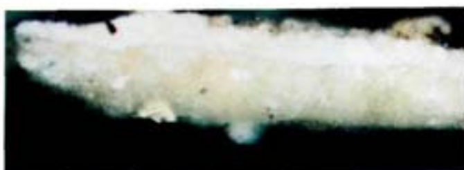
7. kép. Alapozás és festék réteg mikroszkópos keresztmetszete
