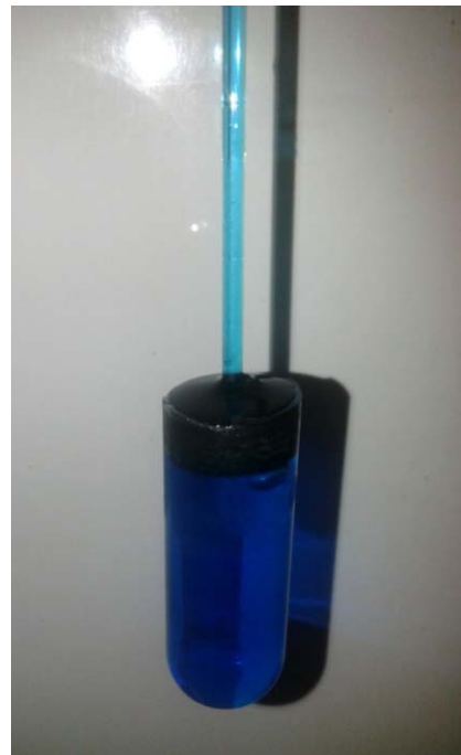
2. ábra. A vízhőmérő a kémcsőből készített tartállyal, amibe az LCD-monitorból kukázott üvegcső kapcsolódik.
