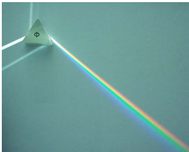
1. ábra. A fehér fény felbontása prizmával. 1
