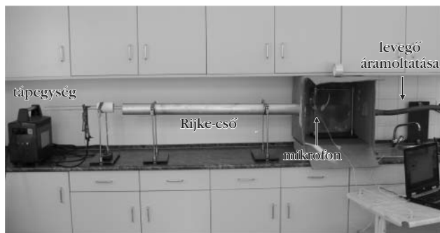
1. ábra. A vízszintes helyzetű, elektromosan fűtött Rijke-cső.
