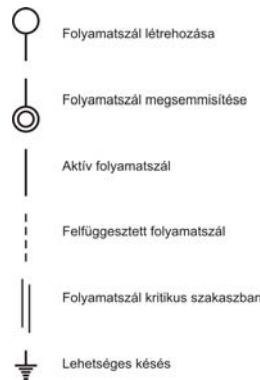
1. ábra Folyamatszálak lehetséges állapotai
