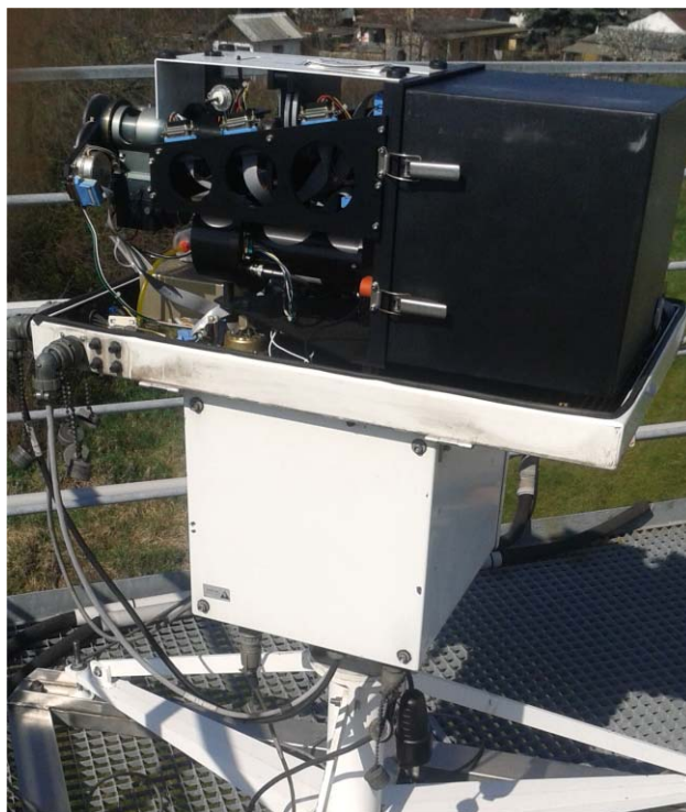
8. ábra. A Budapesten működő (152-es számú) Brewer-spektrófotométer.
