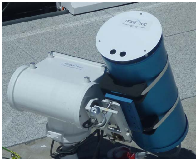
10. ábra. A Napsugárzási Világközpontban kifejlesztett diódasoros spektrofotométer.
