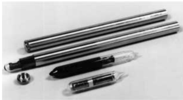
2. ábra. A kapszulanyitás az Eötvös-kísérletben: az acélkapszula, alatta a kissé kihűzött kvarcampulla, azután a fedél és a GaSb ampulla, végül a GaAs ampulla.
